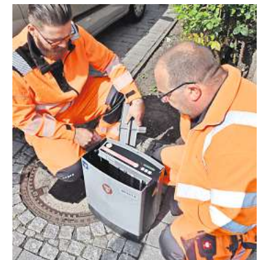
Lenz Krohmer (links) und Andreas Plate bereiten eine Elektro-Rattenfalle zur Installation am Bahnhof vor. FOTO: KATHRIN GÖTZE
